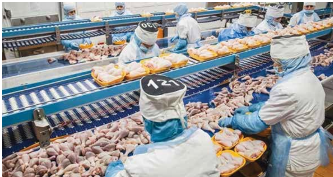
Рис. 3. Работники мясоперерабатывающего комбината «Челны-МПК» в шапках с номерами. Номера помогают системе видеоаналитики рассчитывать индивидуальную выработку.
