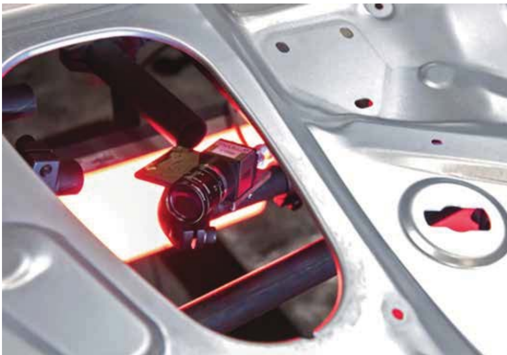
Рис. 6. Камера системы контроля качества работы прессы Audi. Фото из открытых источников
