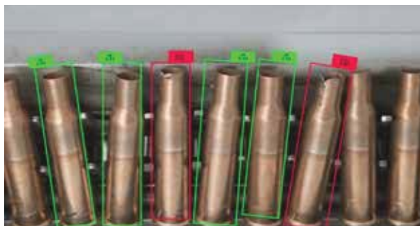
Рис. 5. Скриншот интерфейса системы предотвращения брака на производстве гильз. Видно, что система автоматически распознала и отметила бракованные изделия. Фото из открытых источников
